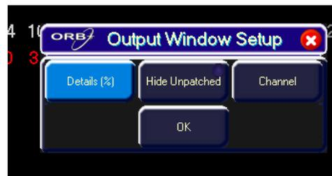
Рисунок 62 – Параметры окна Output Window
