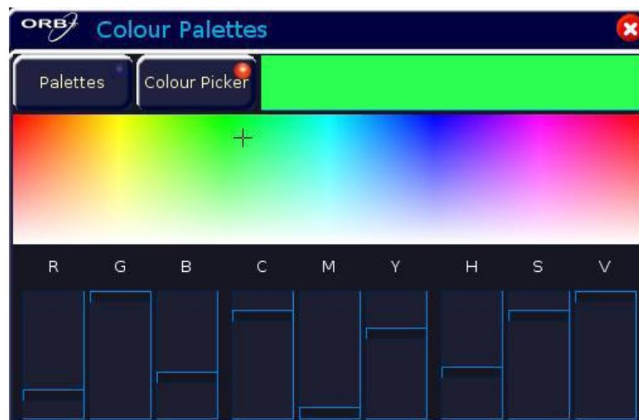
Щелчок на определителе цвета (или касание на сенсорном экране/удаленном мониторе) вызовет установку цвета выбранного прибора в соответствии с введенными значениями. Движение экранных слайдеров будет, соответственно, регулировать эти уровни.
