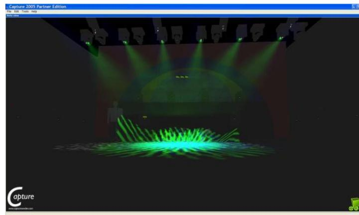
Визуализационное ПО Capture 2005 связывается с консолью при помощи протокола, известного под именем CITP. Этот протокол позволяет использование любой стандартной компьютерной сети между консолью и визуализационным PC. Консоль позволяет Вам конфигурировать либо фиксированный IP-адрес, либо адрес, полученный через DHCP. После того, как два устройства смогут увидеть друг друга, система должна функционировать корректно.
